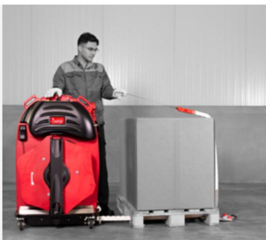
El **elevador de fleje** levanta el fleje del suelo hasta la mano del empleado. El **cabezal de sellado** suelda el fleje de forma segura.
