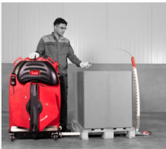
Sube la cadena por detrás del palet y lleva directamente el fleje a la mano del empleado. La **lanza de cadenas** retrocede.
