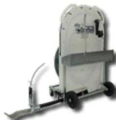
Introducción de la ErgoPack con cadena de 5 metros de longitud, para el flejado de palets más voluminosos, con fleje PP o PET y con un mandril de bobina de 406mm.
